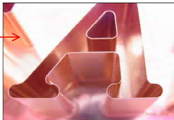
拡大図 先端部寸法 巾 0.12×加工深さ 20mm
