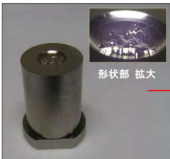
材質 SKH51 (58~60HRC) マシニングセンタ 直彫り加工 (青森県等高線縮尺モデル)
