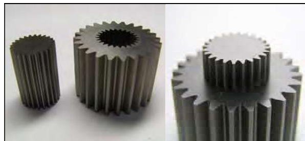
材質 STAVAX (HRC53) 使用機械 FA10P 全周ワイヤー加工(へそ無し加工) 小ギア 精度 0\sim-0.005 大ギア 精度 外形状 0\sim-0.005 中形状 +0.005\sim 0
