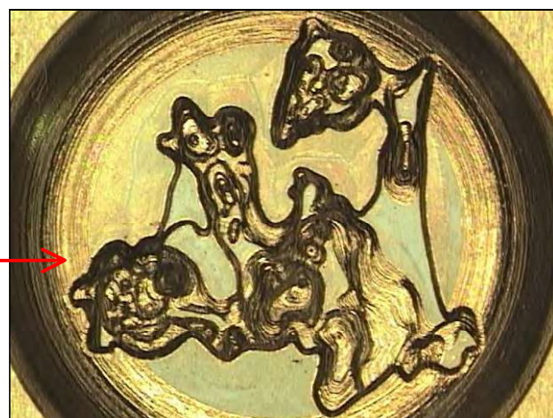
( 尺度 1 / 3 2 0 0 万 ) 使用工具 粗 R 0 . 3 ボールエンドミル 仕 R 0 . 1 ボールエンドミル
