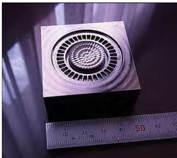
材質 STAVAX (53HRC) マシニングセンタ 直彫り加工
