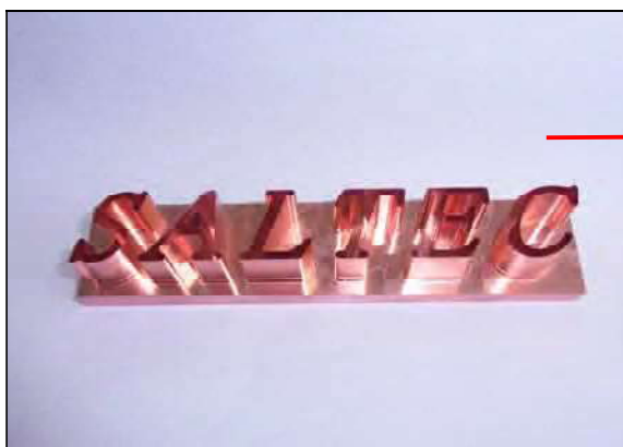
材質 快削銅 マシニングセンタ 直彫り加工
